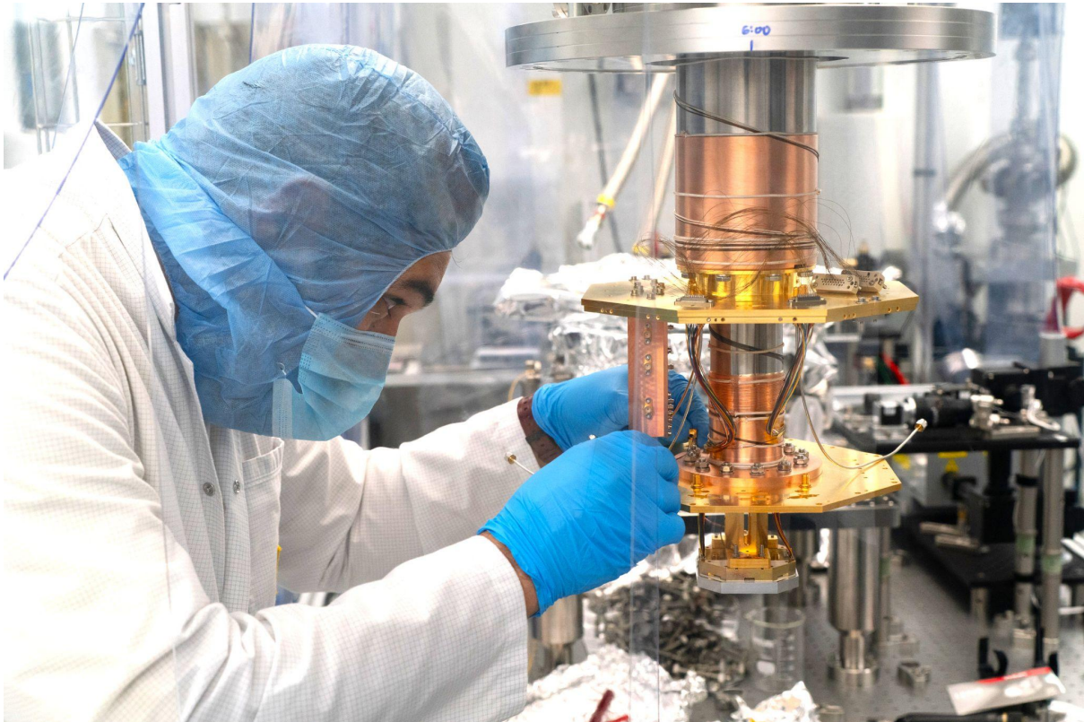
Montage-Arbeiten am Kryostaten von eleQtron © sichtplan
